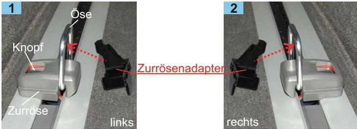
**Bild 1 + 2 Montage Befestigungsteile an die Sitzschienen**
