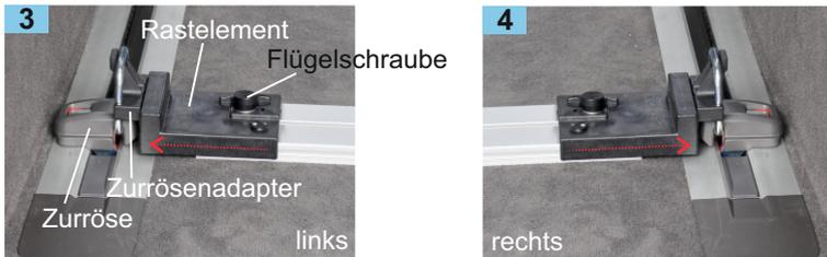
**Bild 3 + 4 Montage RF-Schiene an die Sitzschienen**
