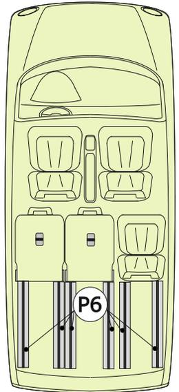
Die RF-Schiene wird an **zwei Sitzschienen** im Fahrzeug befestigt.
