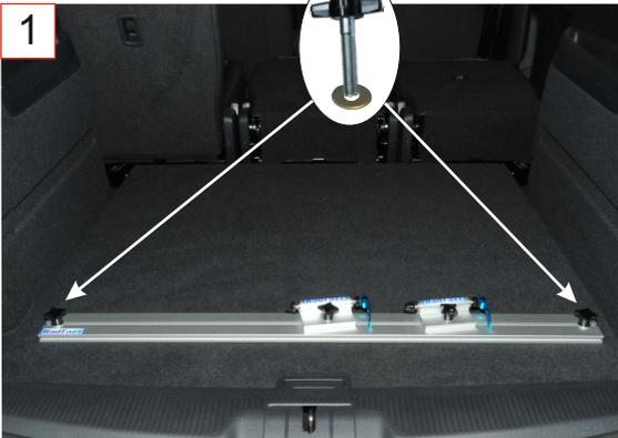
Der Stauraum im Bereich Reserverad ist mit der Bodenplatte abgedeckt. Darauf wird die Fahrradträgerschiene befestigen.
