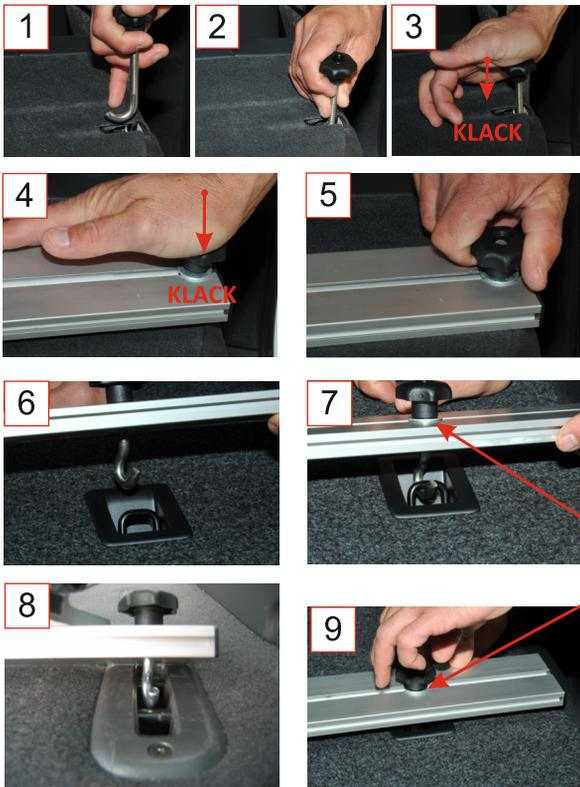
Unsere Konstruktion ermöglicht eine einfache und schnelle Montage der RF-Schiene.
