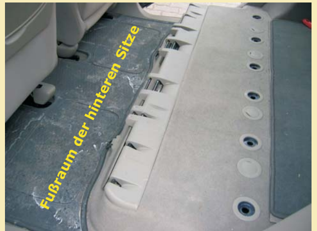
Hier sind sämtliche Sitze im hinteren Bereich ausgebaut. Es ist möglich in den Sitzbefestigungen der hinteren Sitze das Verlängerungs-Adapter-System zu montieren.
